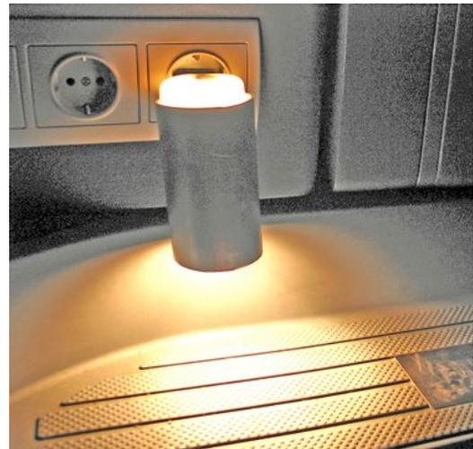
o como **testigo** de que está encendido el inversor de 12 a 220 V para no olvidar dejarlo conectado, o como **consumidor basal** para que no se desconecte automáticamente por *infraconsumo* (función muy habitual en los de gama **senoidal pura**).
