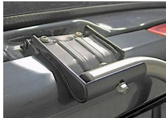
y de donde van suspendidos los largueros verticales que se aseguran con un espárrago transversal sujeto simplemente con una tuerca con freno visible desde el lado posterior.
