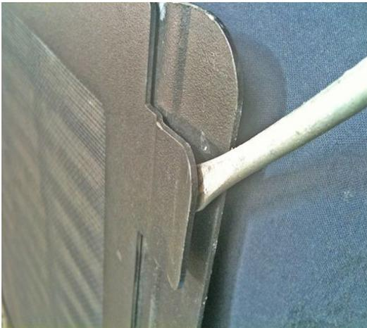
Hace poco nos han contado cómo **han abierto una Viano Marco Polo en Italia para robar en el interior** forzando una de las mosquiteras de las ventanillas correderas aprovechando que se puede **destrozar la separación entre las pestañas que se ajustan al cristal y la chapa troquelada**.
