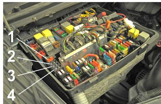
Allí atornillaremos un **terminal de ojal** engastado a un hilo de gran sección (de **10** a **25** mm<sup>2</sup>), como el que se ve en el centro de nuestra caja de fusibles, y partiremos de ahí para **ramificar** varios circuitos debidamente
