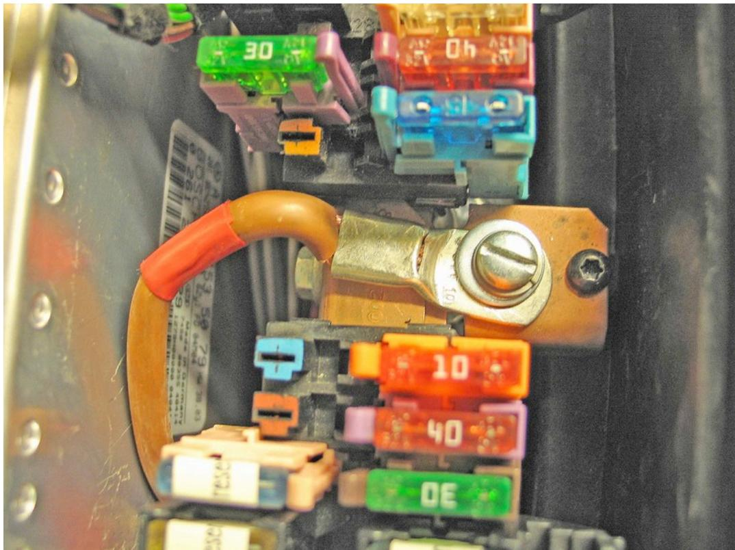
y partir de ahí para **ramificar** varios circuitos debidamente protegidos por sus **fusibles de cabecera** (hemos instalado una **nueva tira de portafusibles**). En este caso, nosotros hemos implementado cuatro líneas nuevas de las cuales sólo la primera tiene en servicio el fusible porque es la única completamente terminada.
