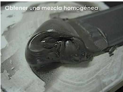
Se aplica **con presión y un poco de exceso** sobre las vaguadas que han dejado las abolladuras, erosiones y desconchados.
