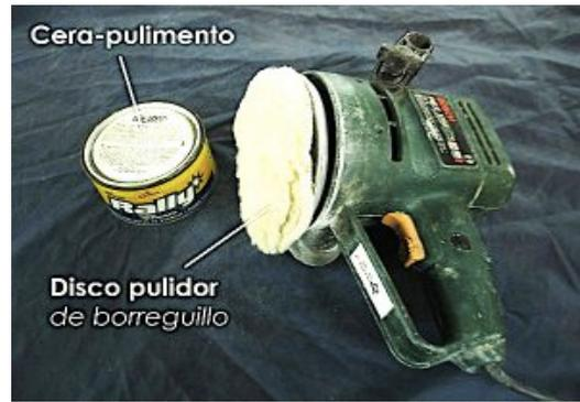
Para empezar, **limpiaremos bien el polvo** de la estancia donde vayamos a trabajar y fregaremos o **regaremos el suelo**. Los lijados los haremos conectando la máquina a un **aspirador** y, con el fin de **no dañar ninguna zona adyacente**, protegemos con varias capas de papel y cinta de carrocería el borde de la zona de trabajo, a ser posible siguiendo **líneas de despiece** de los paños de la carrocería. O, si fuera demasiado grande, trazando una división lo más disimulada y recta posible.
