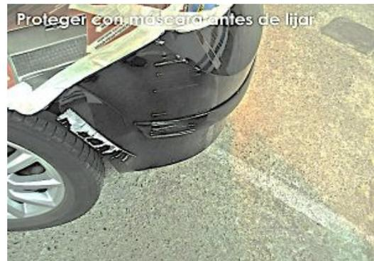
Con el disco de grano 120 en la lijadora **desbastamos** las principales irregularidades y excrecencias de material arrancado y desnivelado.
