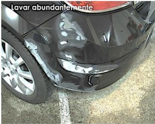
Quedará así listo para **pulverizar la capa de imprimación**, que unificará la superficie, tapaná poros y preparará la pieza para recibir la pintura.
