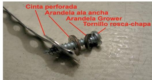
Luego atornillamos las dos cinchas primero del lado de la viga en vertical y luego de la que está en horizontal para hacer las primeras **pruebas de suspensión**.
