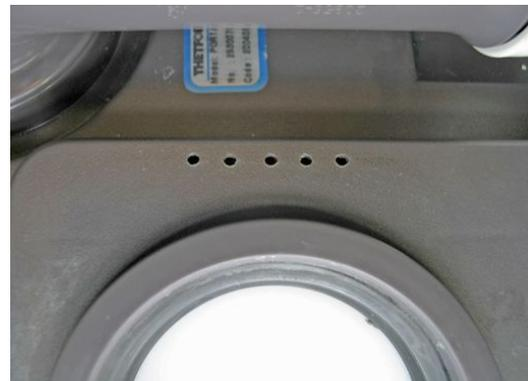
Y allí introducimos con cuidado nuestro *peine de sondas* que quedará bien fijado con una cinta adhesiva de doble cara y por el propio encaje de las patillas.
