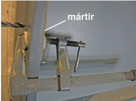
Para que el cable atraviese a la vez la tapa de la caja y el fondo del paralelepípedo de plástico donde tenemos el circuito principal, hay que **hacer coincidir ambos taladros**.
