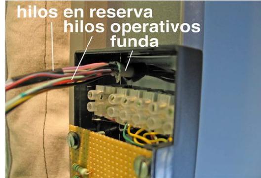
Una vez pegada la cajita con cinta adhesiva de doble cara, **embornamos** el extremo contrario de los siete hilos, **respetando la posición** de las sondas y la alimentación. El mazo de *reserva* lo recogemos para algún uso futuro
