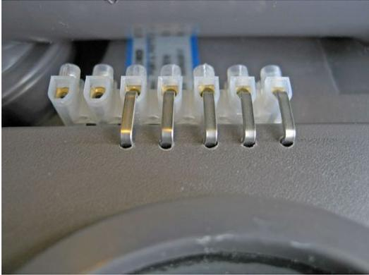
A continuación, desenvainamos de un cable *multihilos* **siete conductores** y los **embornamos** recordando los colores empleados para que coincidan al otro extremo, **cinco para las sondas** y **dos para la alimentación** del aforador que coincidirán con la línea de 12 V que viene del interruptor y del fusible que hayamos previsto antes de hacer el brico. El resto lo dejamos en *reserva*.
