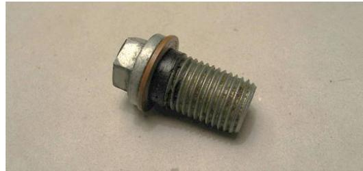
que, como se aprecia, va provisto de una **arandela** de cobre que **no hay que sustituir** nunca. En estos modelos de *furgo* ya no viene la antigua anilla hueca deformable.
