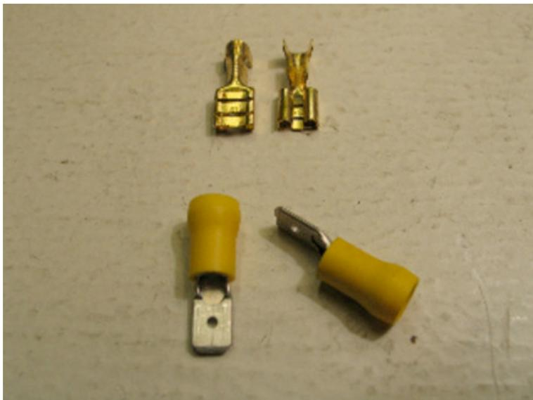
Los *fast-on hembra* los posamos en la parte trasera de un *portarrelés aéreo*
