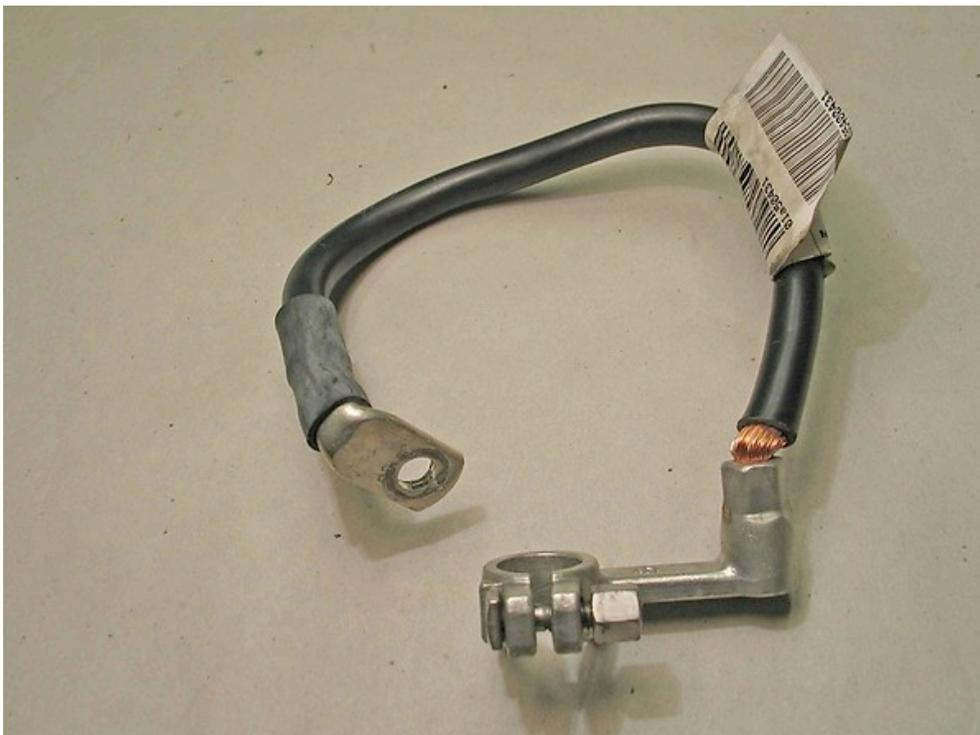
**Tiramos hacia nosotros** del bloque de la batería para operar con más facilidad e insertamos en la borna desnuda una **abrazadera nueva de brazo**
