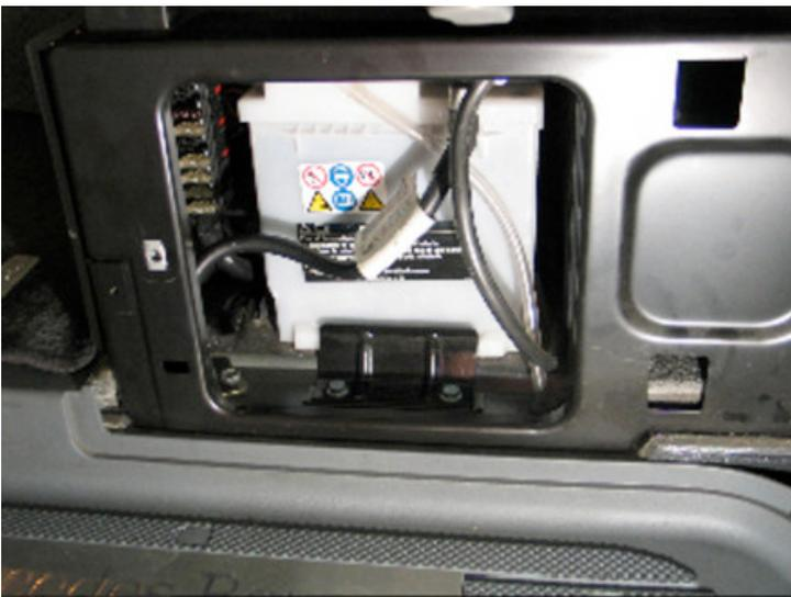
Para acometer este trabajo basta **aflojar** primeramente el **retén** de inercias que mantiene la batería fija en sus carriles (llave del número 10 para las *Mercedes-Benz Viano*)
