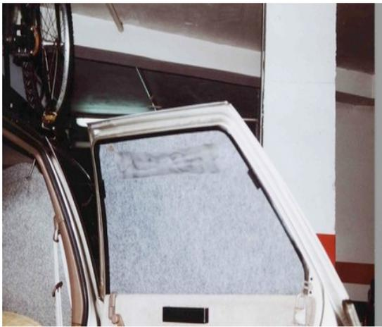
Para ello vamos a hacer unas **plantillas** con papel de periódico, cartulina o simples hojas de papel corriente siguiendo los bordes interiores de los cinco cristales posteriores y luego fijándolos entre sí con cinta adhesiva de modo que al retirarla del cristal nos quede la forma exacta que luego vamos a **calcar en la pieza de moqueta**.
