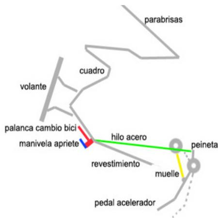
Sólo un pequeño **orificio** en la **moldura** debajo **del volante** nos basta para pasar el cable hasta la contrapalanca o **peineta** del acelerador. Allí la fijamos haciendo un lazo enhebrado en una regleta gruesa de empalmes eléctricos para que no se nos suelte.
