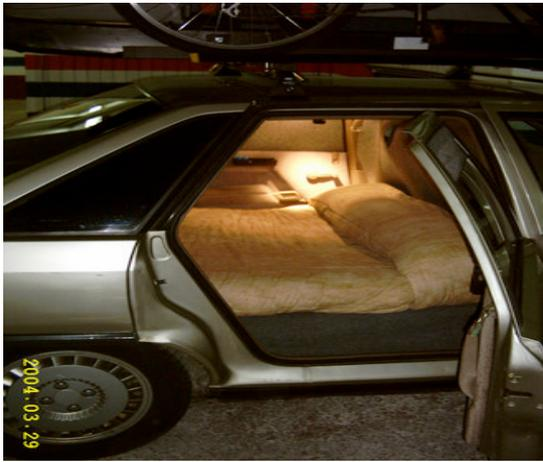
Puesto el colchón sobre la plataforma enmoquetada, todo el alojamiento del maletero nos sirve para poner la parte inferior del cuerpo. Como este cofre suele ser más frío en invierno, hay que **forrar interiormente la tapa del maletero** con la moqueta aislante, igualmente haciendo una plantilla de papel. Cortada la pieza, la atornillaremos a la chapa.
