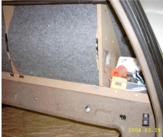
Hay que recortar en cartulina tres piezas para que nos sirvan de patrón de las tablas de aglomerado o de fibras de densidad media (DM) con las que queremos construirlo. Bastan **tres piezas verticales**, una en medio y dos a los lados sin llegar a los extremos, y **cuatro baldas** o repisas horizontales, con lo que nos resultarán seis compartimentos dentro del armario y dos mesillas de noche en los extremos.
