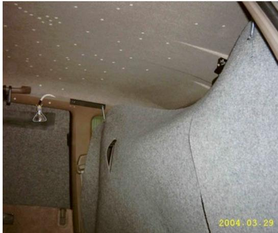
La cortina tiene **dos cortes paralelos rectos** terminados en círculo a la altura del espacio entre asientos para que podamos entrar cómodamente de la parte delantera a la trasera sin necesidad de retirar toda la pieza. El corte empieza abajo y termina unos centímetros antes de la parte superior por la que en todo su tramo horizontal discurre una tira encolada del mismo material para darle rigidez y forma.
