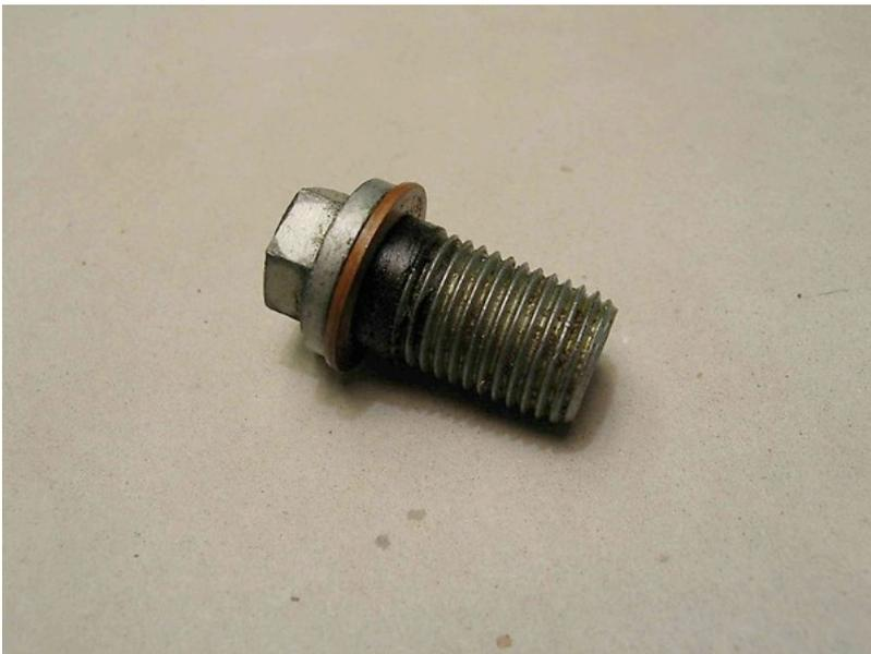
que, como se ve, va provisto de una **arandela** de cobre que **no hay que sustituir** nunca. En estos modelos de *furgo* ya no viene la antigua arandela hueca deformable.
