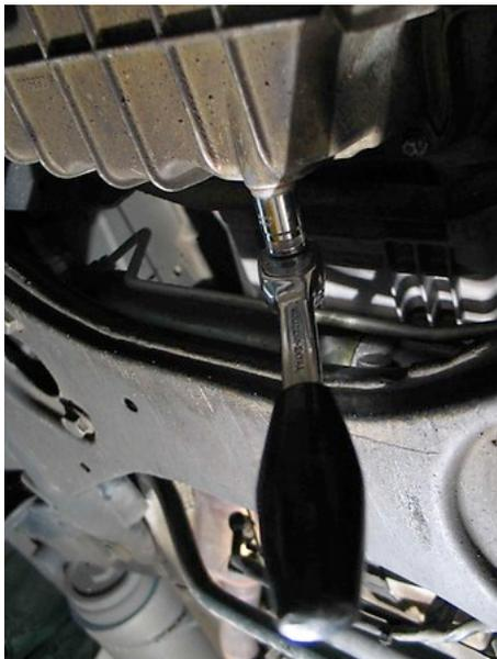
de que el **potente chorro de aceite usado** que saldrá al retirarlo caiga exactamente **dentro** del plato recogedor del bidón.
