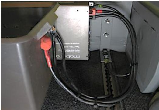
Finalmente se introduce la tercera batería en su hueco, que está sobredimensionado por si en otro momento se desea cambiar por una de mayor capacidad, por ejemplo, una de 100 ó 150 Ah.
