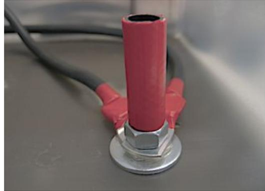
Estos tornillos enfundados nos pueden servir también para, en el caso de quedarnos sin batería o de tener que **auxiliar a otro automovilista**, poder fijar la pareja de pinzas de arranque cómodamente sin tener que ir al motor. Muy útil para nosotros en caso de lluvia y menos perjudicial para la *electrónica* del motor que no recibirá salpicaduras.
